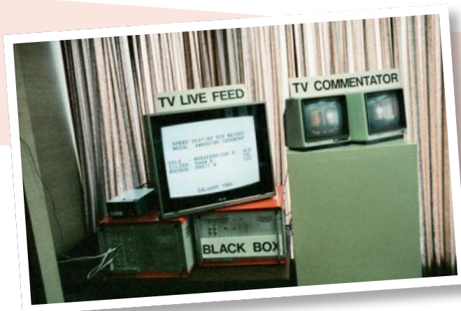
„TERA-Black Box” uređaji koji su generirali TV-signal koji je sadržavao grafički prikaz rezultata
