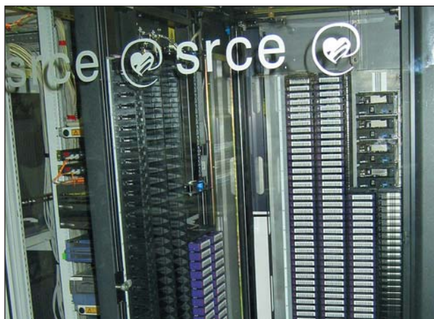
Unutrašnjost robotskog dijela središnjeg sustava za pohranu podataka (backup)
